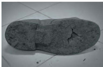
Подошва разрушилась от контакта с нагретой поверхностью
